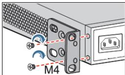
Прикрутите болты и установите устройство в стойку. Внимание: оставляйте промежутки между оборудованием не менее 1 U для теплоотвода.
