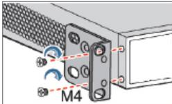
Прикрутите винты и установите устройство в стойку. Внимание: оставляйте промежутки между оборудованием не менее 1U для теплоотвода.
