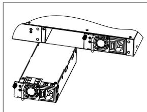
Для установки блока питания возьмитесь одной рукой за специальную ручку, после чего медленно и аккуратно вставьте блок питания в коммутатор, другой рукой придерживая его за заднюю часть. После закрутите винт крепления.
