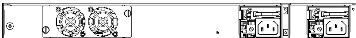
Рисунок 1.4- Задняя панель коммутатора SNR-S300G-24FX в полной комплектации.
