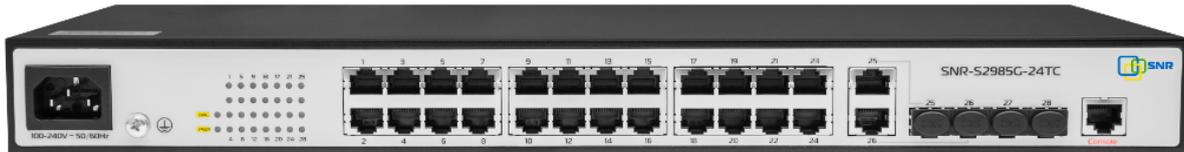
Рисунок 1.2— Передняя панель коммутатора SNR-S2985G-24TC.
