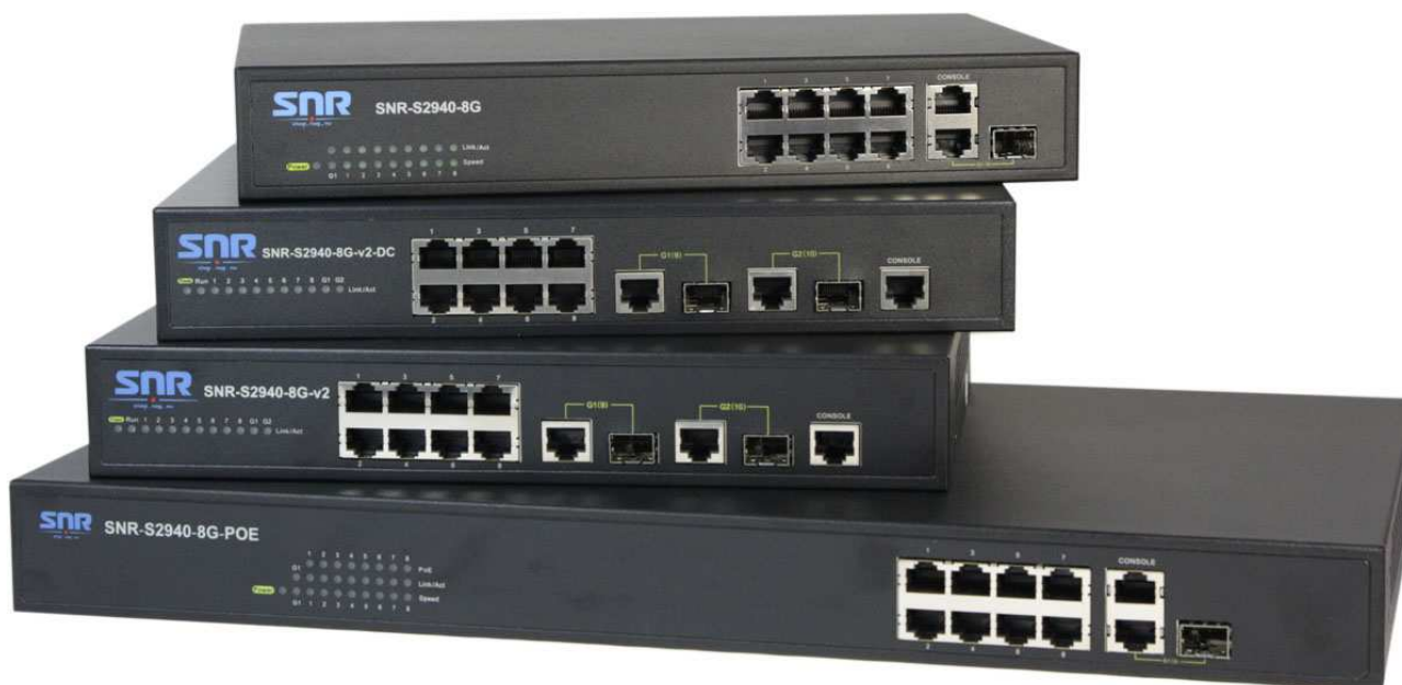
Рисунок 1. Вид передней панели коммутаторов SNR-S2940
