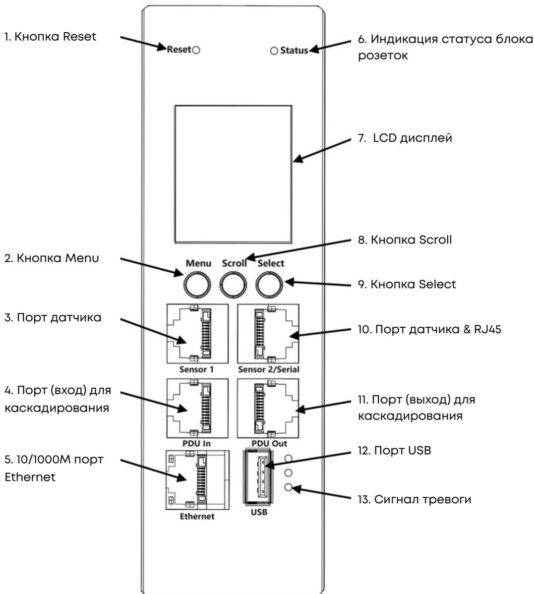
РИСУНОК 2 – ПАНЕЛЬ КОНТРОЛЛЕРА
