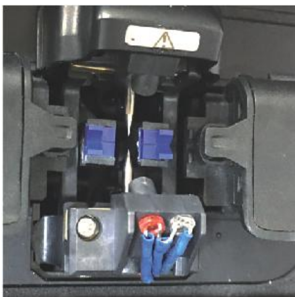
13. Произведите замену второго электрода аналогичным образом.
