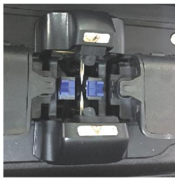
14. Закройте крышку электрода. Замена обоих электродов завершена.
