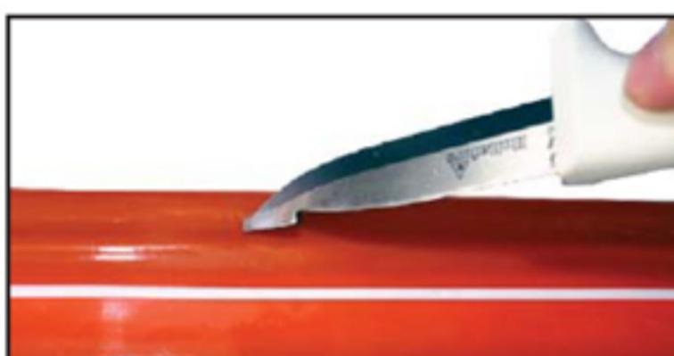
Поместить нож между двумя внешними трубками и осторожным нажатием/поворотом сделать
