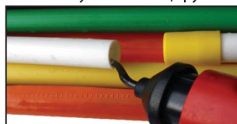
Следует снять фаску на микротрубке. Важно снять фаску на обеих трубках.
