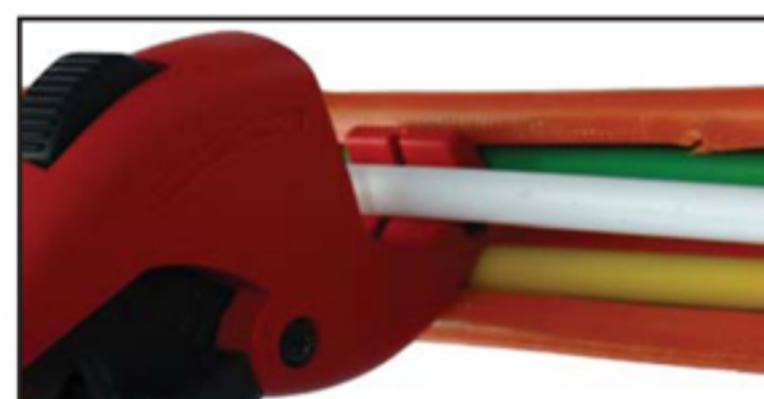
Поместить резак под трубку и перерезать ее. Не забудьте надеть концевую пробку на неиспользуемый конец трубы.
