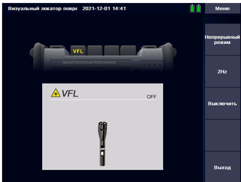
Рисунок 13 - Визуальный локатор повреждений VFL
