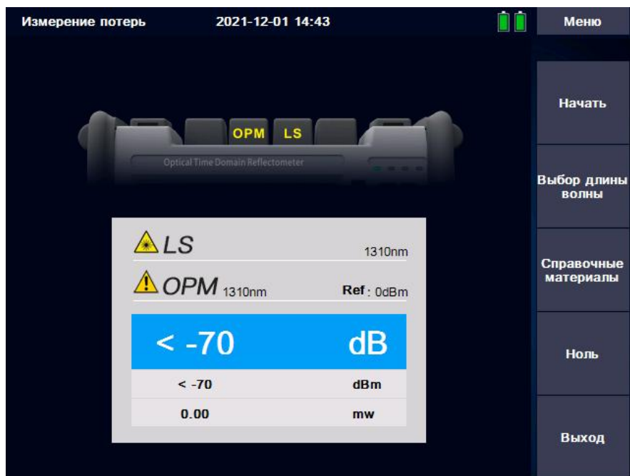
Рисунок 15 - Измерение потерь в оптической линии
