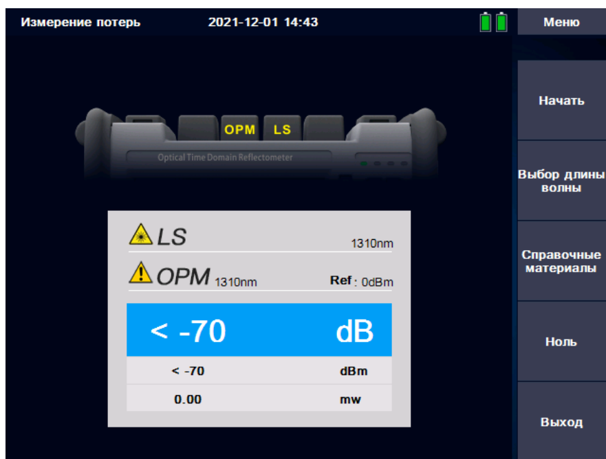
Рисунок 15 - Измерение потерь в оптической линии
