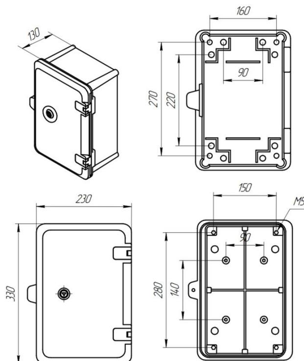
Рисунок 10 – Габаритные размеры SNR-FWC-233315-IP65
