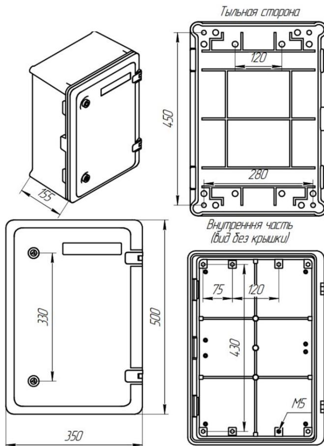
Рисунок 12 – Габаритные размеры SNR-FWC-355020-IP65
