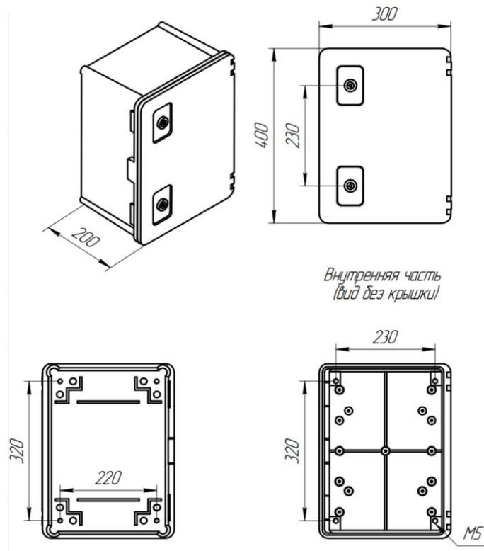
Рисунок 11 – Габаритные размеры SNR-FWC-304020-IP65
