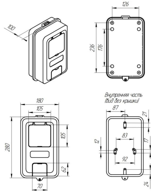
Рисунок 9 - Габаритные размеры SNR-FWC-182810-IP54
