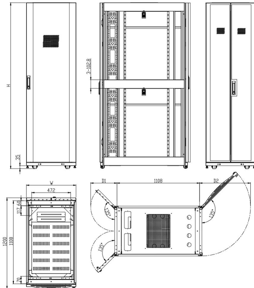
Рисунок 3 - Габаритные размеры шкафа MetalBox глубиной 1200 мм.
