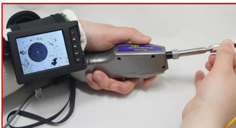
Монитор, оснащенный видеошупом, предназначен для удобного просмотра изображения в реальном времени. Монитор может фиксироваться на руке пользователя для максимального удобства работы, просмотра данных и изображения.
