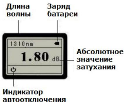
Если батарея разряжена (индикатор дисплея - ), извлеките и зарядите ее. В случае зарядки батареи, вы можете подключить устройство к внешнему источнику питания. Значок на дисплее «» означает, что устройство работает от внешнего питания.
