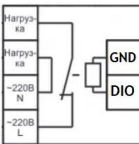
Рисунок 13 - Управление внешним реле при помощи DIO в режиме «выхода»
