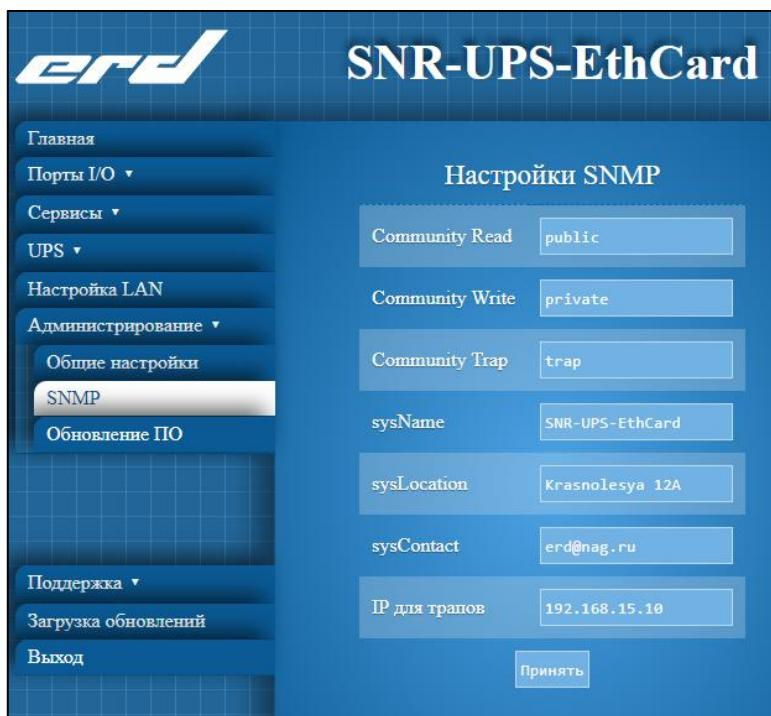
Рисунок 11 – Настройка SNMP-агента модуля
