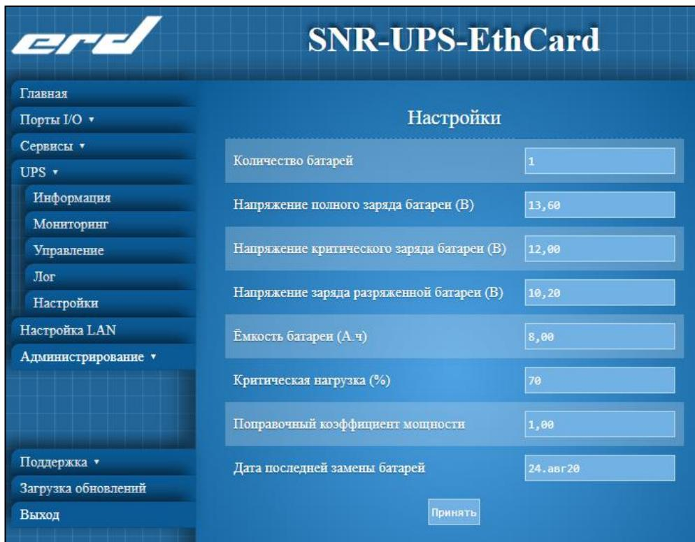
The screenshot shows the configuration interface for the SNR-UPS-EthCard. The top navigation bar includes the erD logo and the device name "SNR-UPS-EthCard". The left sidebar contains a menu with the following items: Главная (Home), Порты I/O, Сервисы, UPS, Информация, Мониторинг, Управление, Лог, Настройки (highlighted in blue), Настройка LAN, Администрирование, Поддержка, Загрузка обновлений, and Выход.
