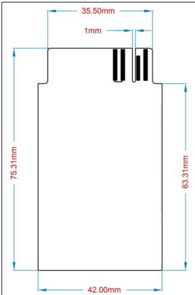
Рисунок 2 – Размеры печатной платы модуля SNR-SNMP-CARD-801
