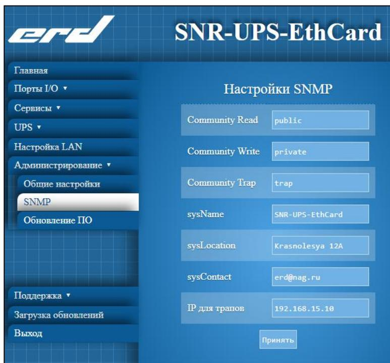
Рисунок 11 – Настройка SNMP-агента модуля
