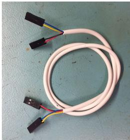
Для передачи управляющих сигналов “power” и “reset” на материнскую плату, используется кабель №1, входящий в комплект устройства (Рисунок слева). Подключение кнопок “power” и “reset”, а также одноимённых сигналов на материнскую плату, выполняется без соблюдения полярности.
