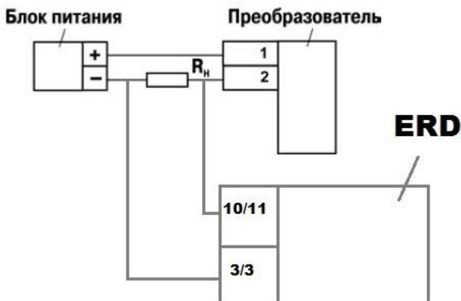
Рисунок 11 – подключение преобразователя к входу АЦП
