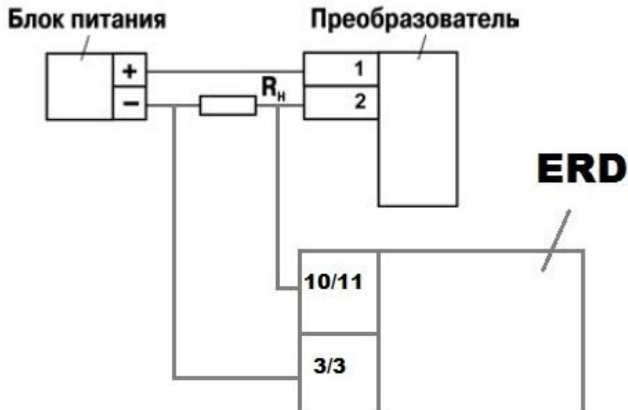
Рисунок 11 – подключение преобразователя к первому входу АЦП
