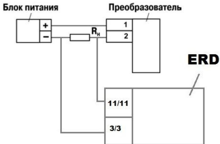
Рисунок 12 – подключение преобразователя ко второму входу АЦП
