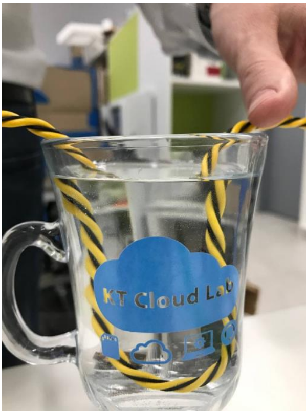
Рисунок 7 Погружение кабеля в воду на 150мм и напряжение
