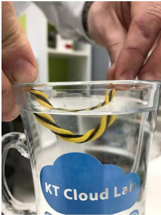
Рисунок 6. Погружение кабеля в воду на 50мм и напряжение
