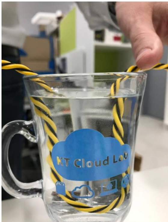
Рисунок 16 Погружение кабеля в воду на 5мм и напряжение
