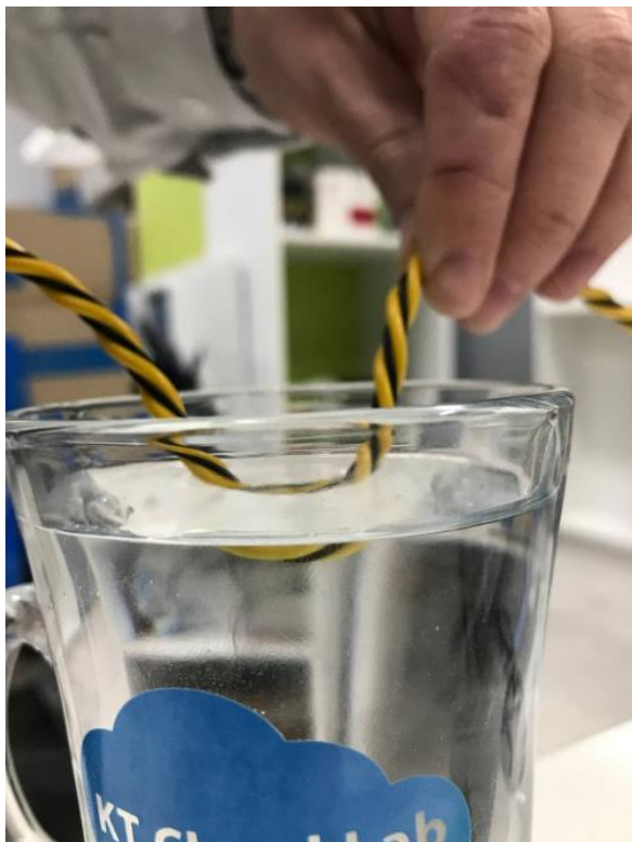
Рисунок 14 Погружение кабеля в воду на 5мм и напряжение
