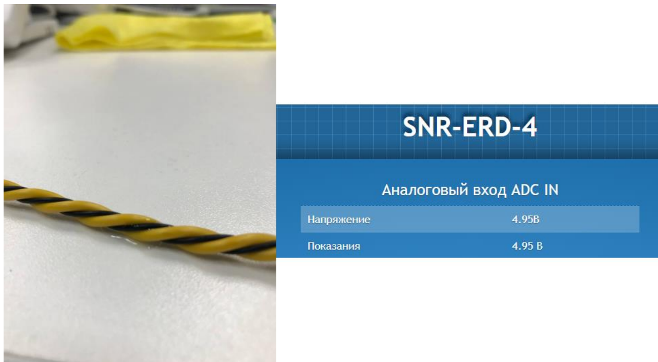
Рисунок 3. Капля воды на кабеле и напряжение
