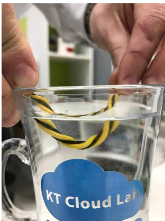
Рисунок 15 Погружение кабеля в воду на 50мм и напряжение
