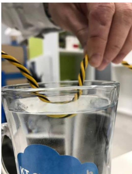
Рисунок 5. Погружение кабеля в воду на 5мм и напряжение
