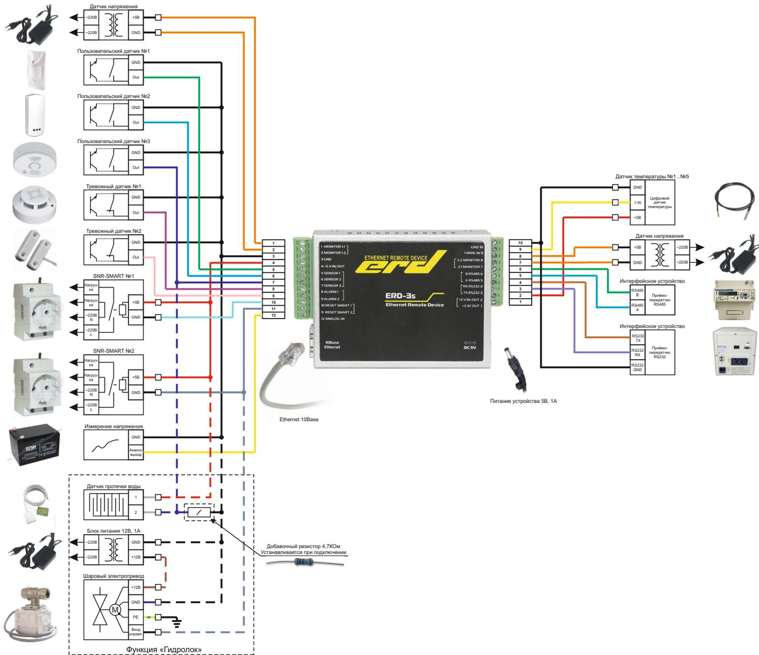
При использовании данной функции, исключите из схемы пользовательский датчик №3 и управляемую розетку SNR-SMART №2
