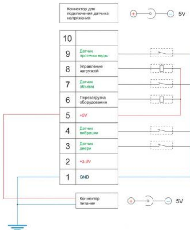
Рисунок 4 – Схема подключения датчиков и управления нагрузкой
