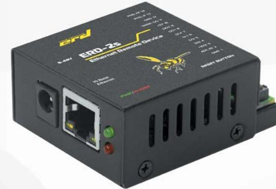
Предназначено для удалённого контроля температуры, управления нагрузками, состояния инженерных систем серверной и шкафов с оборудованием, ЦОД
