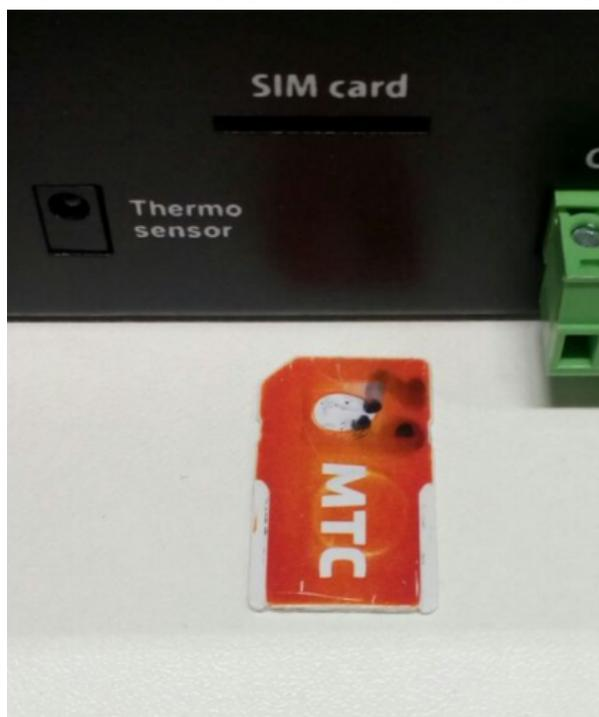
Рисунок 20 - порядок установки SIM карты
