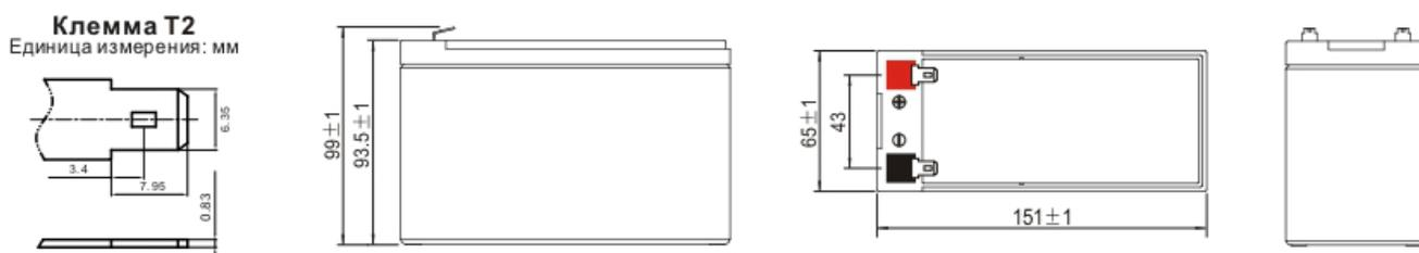
Рисунок 8 – Габаритные размеры аккумулятора
