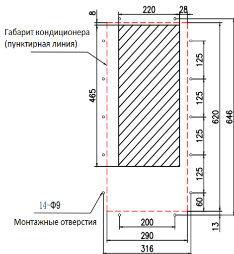
РИСУНОК 2 – Монтажные размеры SNR-ACC-680-ACH
