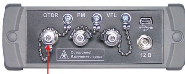
Разъем рефлектометра для ОВ
