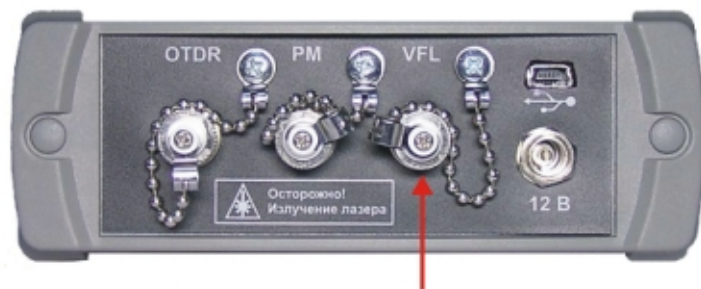
Разъем для ОВ при визуализации места повреждения
