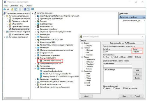
3. Включаем питание регистратора, при правильном подключении контактов TX,RX,GND и serial COM сразу появится информация о загрузке регистратора в терминале.
