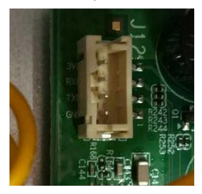
2. Открываем терминал, выбираем serial, скорость 115200 в нашем примере мы используем программу Putty, можно использовать любой другой аналог.
