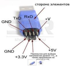
b) Припаять контакты к UART напрямую без использования разъёма.
