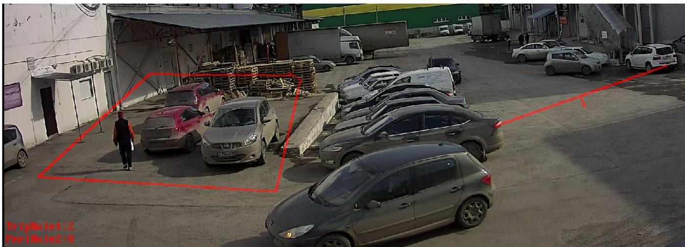
На картинке видно как человек зашел в периметр, и машина пересекла линию. Камера фиксирует количество тревожных событий и может отправить snapshot на email. Зафиксированные события отображаются на экране камеры.
