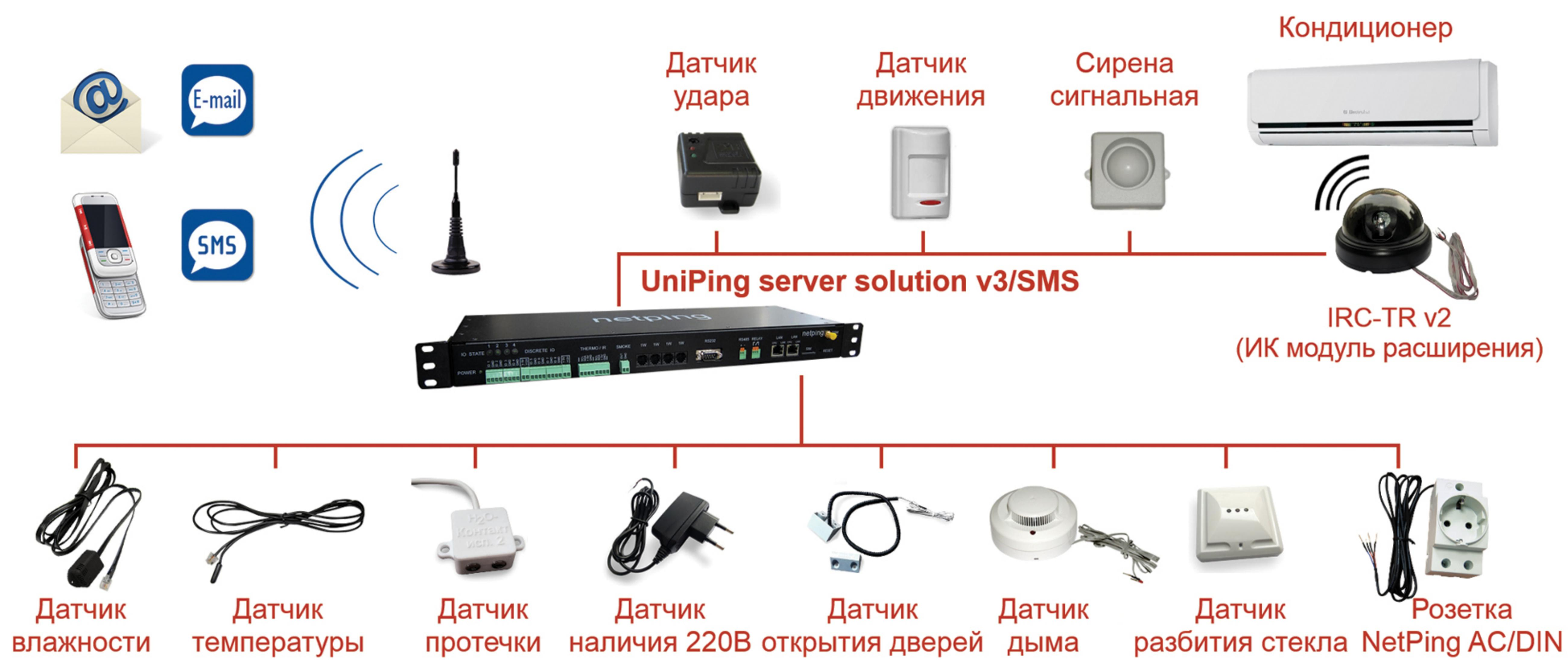
**UniPing server solution v3** без встроенного GSM-модема является упрощенной модификацией устройства **UniPing server solution v3/SMS**. Данное устройство имеет аналогичный функционал, кроме отправки SMS-уведомлений и получения SMS-команд.
