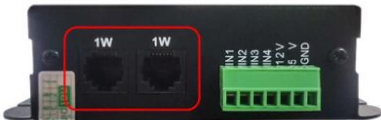
Устройство оснащено двумя независимыми портами 1-wire. Это означает, что общий вес 1-w сети может составлять до 100 метров. Длину так же можно увеличить за счет [NetPing удлинитель-разветвитель 1-wire на 5 портов, модель R912R1](#).
