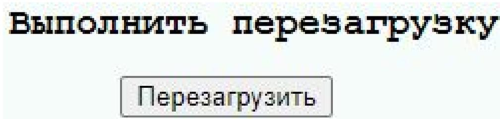
При нажатии на кнопку **«Продолжить»** желтые светодиоды CPU у портов Ethernet мигнут несколько раз, и прошивка перезапустится. Время непрерывной работы устройства сбросится в 0д 0ч 0м 0с.
