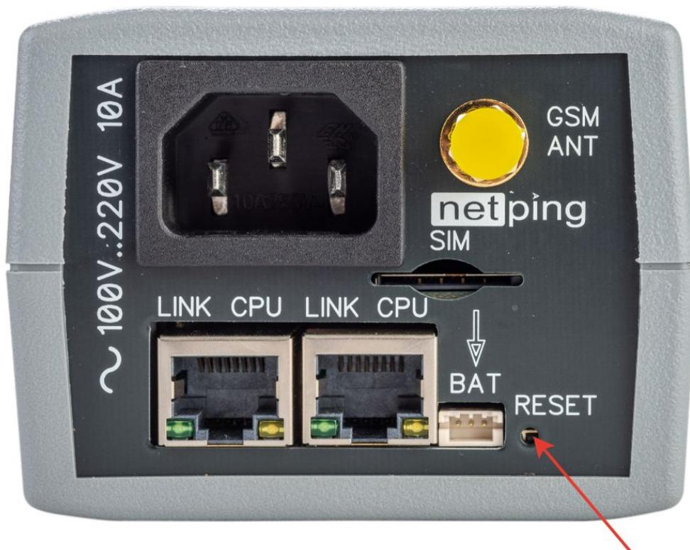
Кратковременное нажатие на кнопку сброса параметров «Reset» перезагружает устройство.
