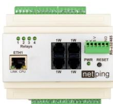
Устройство удаленного мониторинга датчиков и управления по сети Ethernet на DIN-рейку.
