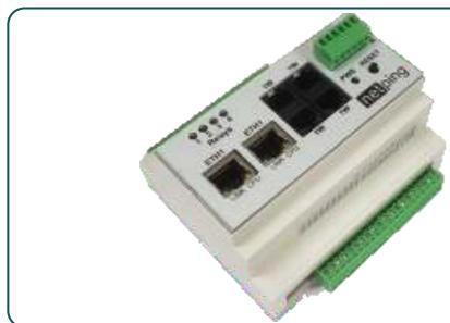
Устройство удаленного мониторинга датчиков по сети Ethernet/Internet на DIN-рейку. Позволяет удаленно получать информацию о состоянии датчиков и уведомления о срабатывании датчиков, управлять подключенными устройствами. Наличие встроенного web-интерфейса, HTTP API, SNMP, SNMP Trap, SMTP, Syslog, модулей Сторож и Расписание, фильтра доступа, NTP.
