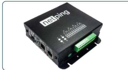
Компактное устройство удаленного мониторинга подключаемое к сети Ethernet/Internet. Позволяет удаленно управлять внешними устройствами и оборудованием и получать уведомления и информацию о состоянии датчиков. Наличие встроенного web-интерфейса, HTTP API, SNMP, SNMP Trap, SMTP, Syslog, модулей Сторож и Расписание, фильтра доступа, NTP.
