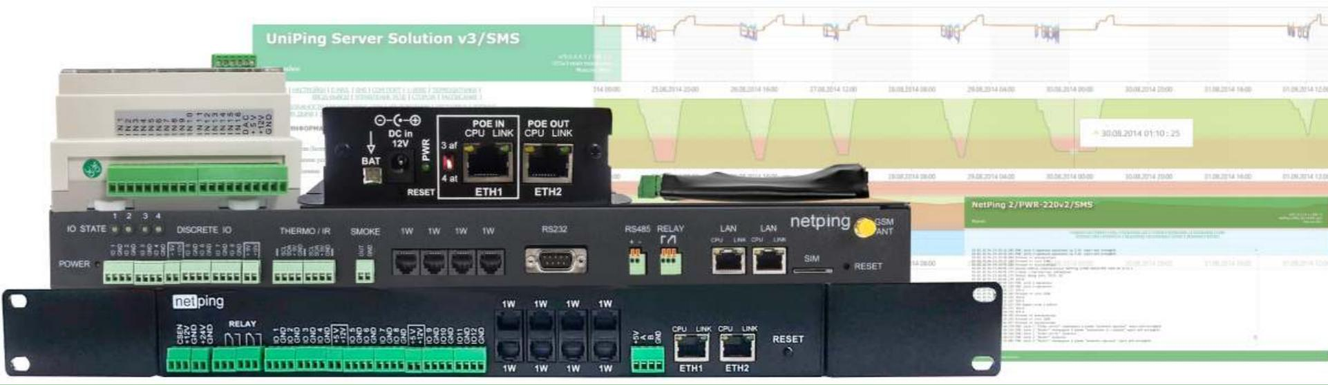
Устройства удалённого мониторинга окружающей среды предназначены для контроля параметров стоек, коммутационных узлов, серверных комнат, помещений data центров, на объектах, где важно следить за условиями работы дорогостоящего оборудования. Наши устройства позволяют получать значения температуры, влажности, задымлённости, протечки, открытия дверей, наличия напряжения, движения, удара, воздушного потока.
