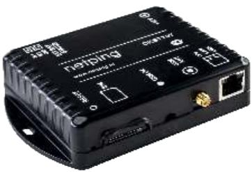
GSM шлюз позволяет отправлять и получать SMS-уведомления и выполнять SMS-команды, передаваемые по сети Ethernet/Internet, как для устройств NetPing/UniPing, так и для других сетевых устройств. На базе SNMP Trap сообщений.
