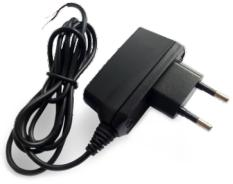
► **Датчик наличия 220 В.** Позволяет определить наличие напряжения в розетке питания. Диапазон рабочих напряжений: 80 В-250 В. Датчик выполнен в виде адаптера под евророзетку. При необходимости мониторинга за трехфазным напряжением требуется установка датчиков на каждую фазу. Максимальное удаление датчика от устройства NetPing – 100 метров.
