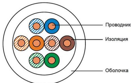
Кабель предназначен для использования в структурированной кабельной системе 5, 5е и 6 категории. Кабели 6 категории наиболее часто используются для таких стандартов Ethernet как 10Base-TX, 100Base-T и 1000Base-T.
