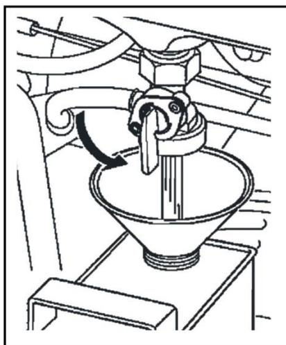
Для слива остатков топлива из карбюратора, ослабьте сливной винт на корпусе карбюратора, при помощи отвертки. Для GG2500X открутите сливную пробку.
