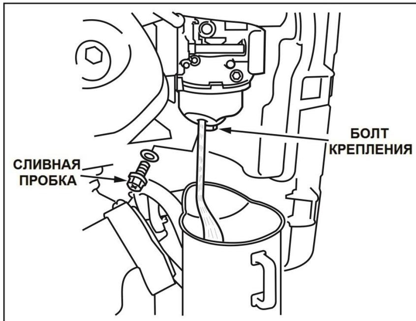
3. Открутите болт крепления и снимите стакан отстойника.
