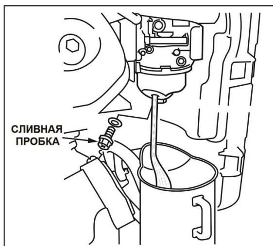
**ВНИМАНИЕ!** При длительном хранении бензин окисляется и загрязняет топливную систему и может стать причиной выхода двигателя из строя. Гарантия не распространяется на повреждения топливной системы или двигателя, вызванные пренебрежительной подготовкой к хранению.
