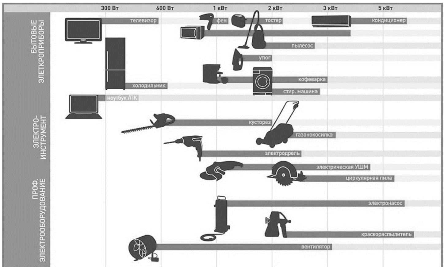
В расчет следует принимать мощность каждого потребителя, вплоть до лампочки. Обычно мощность прибора в кВт показана на заводской табличке или в паспорте изделия. Либо можно использовать усредненные данные (см. рисунок). После всех подсчетов должна получиться необходимая мощность ГУ.
