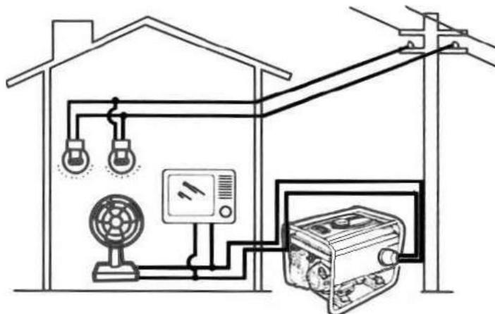
Подключение ГУ к общей электросети, в режиме ожидания, должно производиться квалифицированным электриком, с соблюдением действующих законов и правил электробезопасности.
