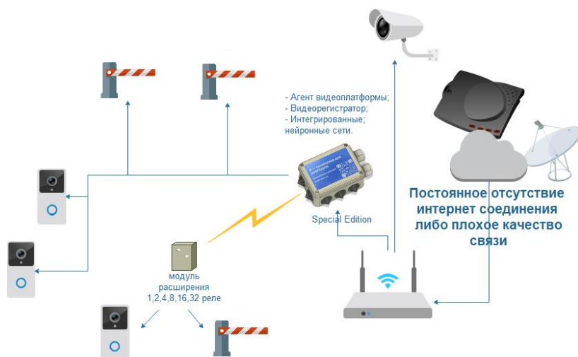
Рис.3. Подключение контроллера SIRIN LACKEY, требуется прокладка кабеля связи до подъезда/шалгбаума/калитки.
