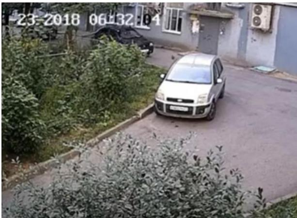
Камера с достаточно низким разрешением, автомобиль видно, а номер нет. В зависимости от камеры нужно настроить фокус или перевесить её так, чтобы номер был виден.
