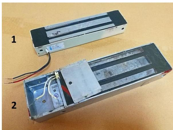
Рисунок 2 - 2 типа замков: 1 - без монтажного отсека, 2 - с монтажным отсеком
