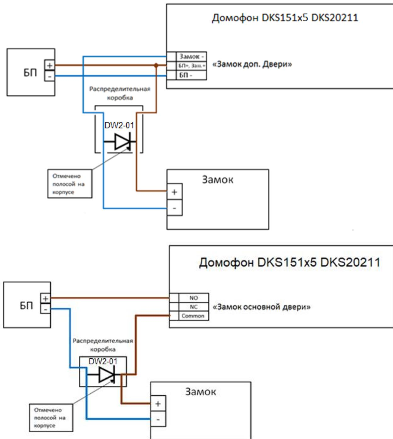
Рисунок 3- Схема подключения замка без монтажного отсека
