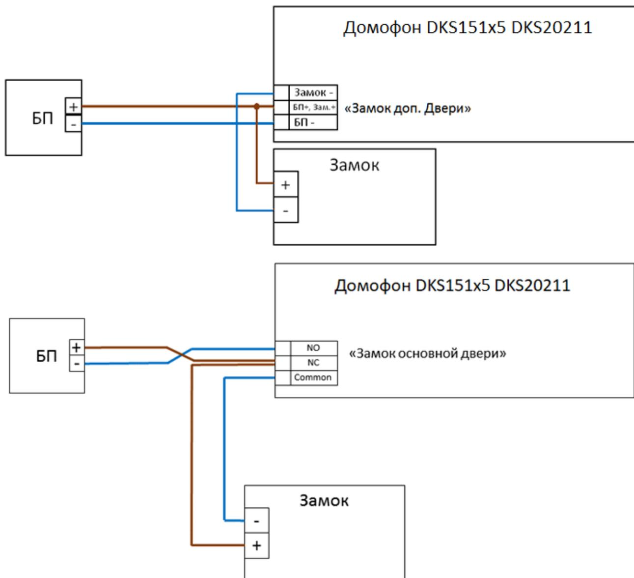
Рисунок 1- Схема подключения замка со встроенным диодом
