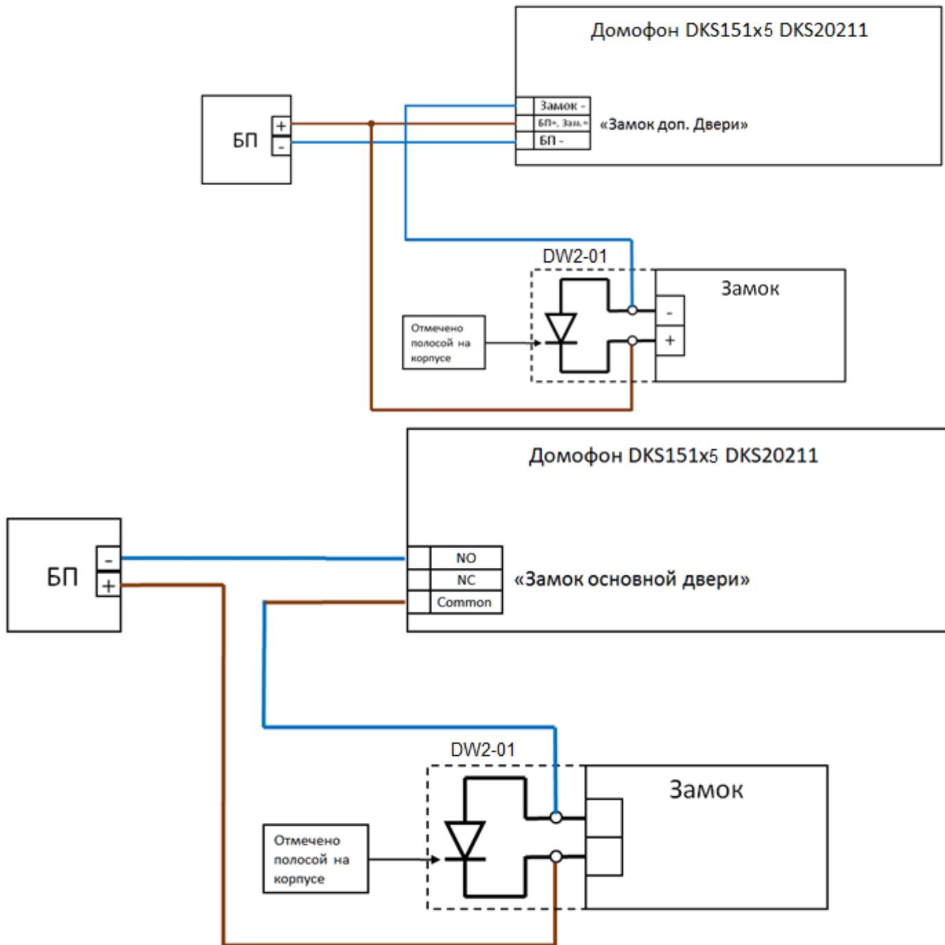
Рисунок 4- Схема подключения замка с монтажным отсеком
