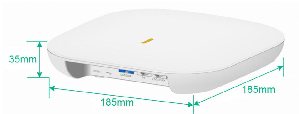
图2-78 设备尺寸示意图
