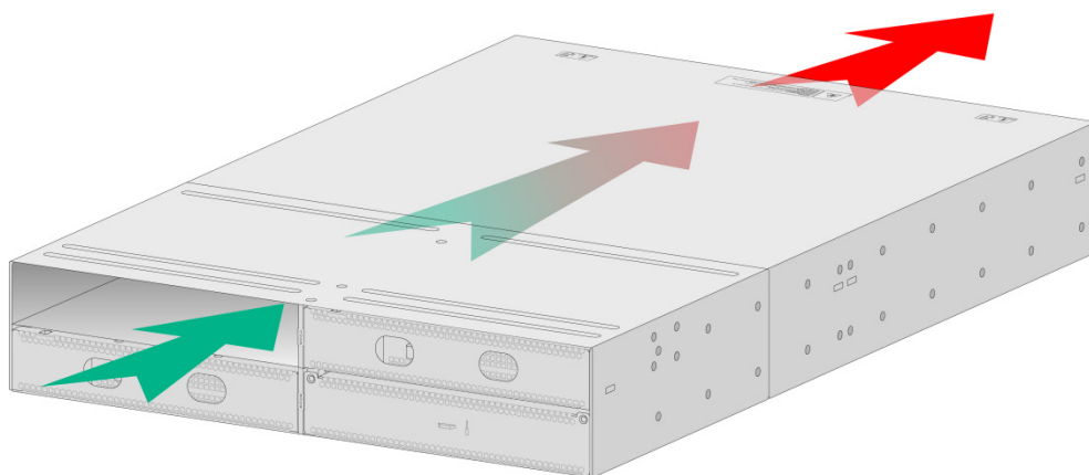
图4-1 端口侧进风，电源侧出风的散热方式
