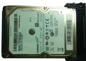
② Убедитесь в том, что жесткий диск обращен вверх своей своей металлической поверхностью, затем вставьте жесткий диск горизонтально. Когда диск займет правильное положение, стойки с обеих сторон смогут зафиксировать расположенные на диске отверстия под винты крепления.
