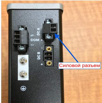
Рис. 8 Отсоединение силовых разъемов от коммутатора
