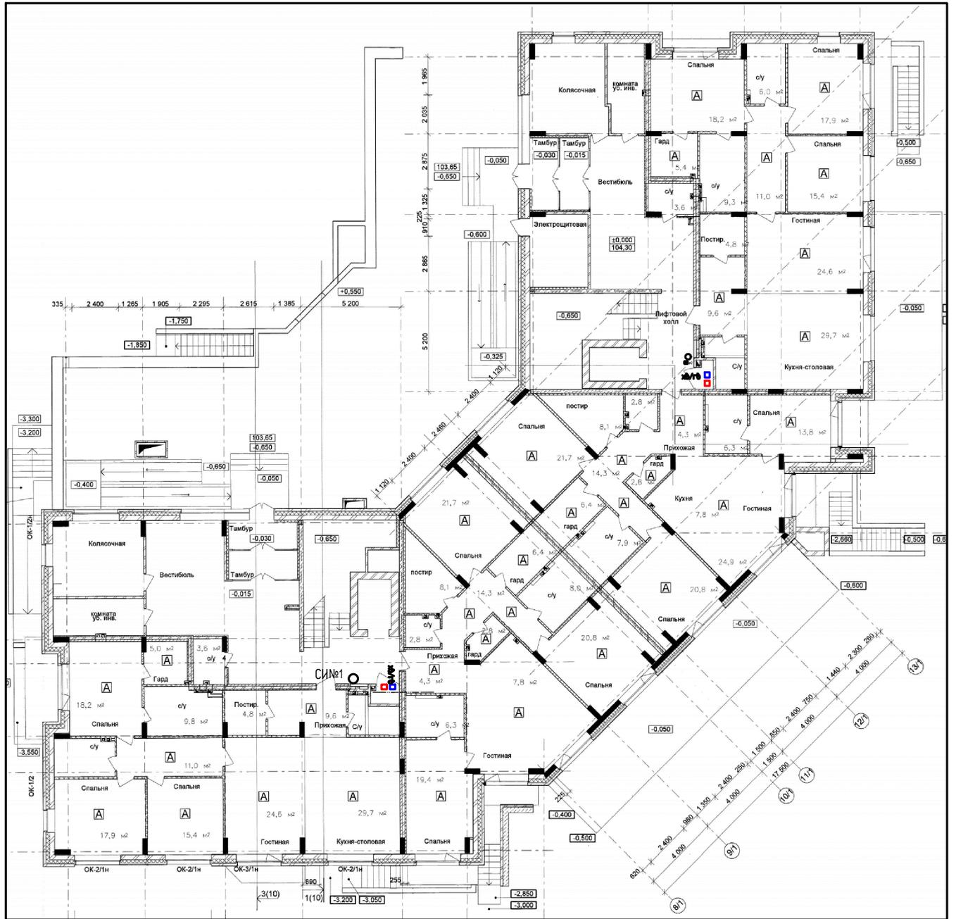
СИ№1 ○ — Места установки счетчиков импульсов
