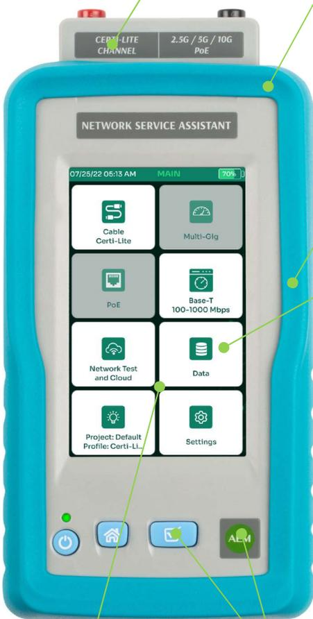
**Карта разводки в реальном времени** При подключении к линии, NSA издает звуковой сигнал и показывает схему разводки и целостность как для медных, так и для оптоволоконных кабелей.
