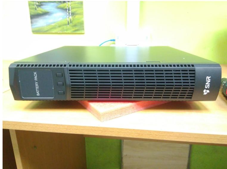
1. Снимаем с лицевой части ББ (блока батарей) защитный кожух как показано на рис. 1.
