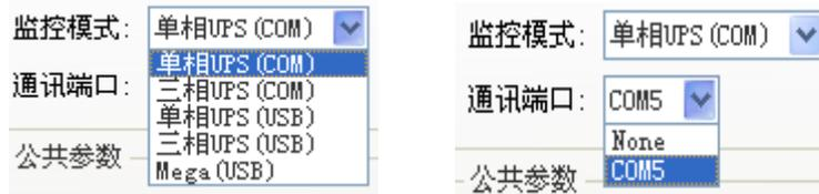
通讯端口：通讯端口只有选择了监控模式为串口连接时才可以进行选择，此时如果连接都已经连接好，通讯端口可以自动检测到串口号，直接选择就可以了。在选择了USB连接模式时软件会自动查找连接，无需手动再进行设置。如图：选择单相串口连接时再选择对应的通讯端口。
