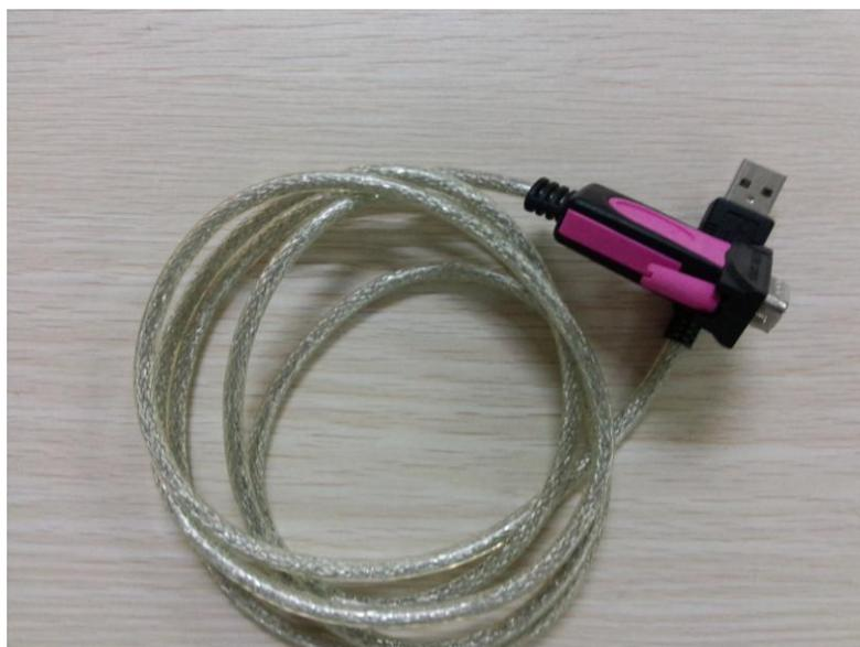
串口转 USB 连接线
