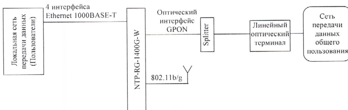
**2.7. Электрические (оптические) характеристики:** Электрические параметры интерфейсов к сети передачи данных Ethernet соответствуют требованиям Приложения 25 «Правил применения оборудования проводных и оптических систем передачи абонентского доступа». Параметры оптического стыка: мощность передатчика от +0,5 до +5 дБм; уровень сигнала на входе приемника от -28 до -8 дБм; длина волны 1310/1490 нм.
