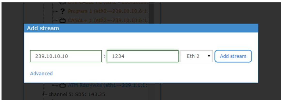
Также можно добавить параметры IGMPv3 – **include** (включая указанный IP мультикаст) или **exclude** – (исключая указанный IP мультикаст)
